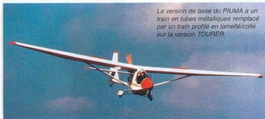
La version de base du Piuma a un train en tubes métalliques remplacé par un train profilé en lamellé/collé sur la version TOURER.
