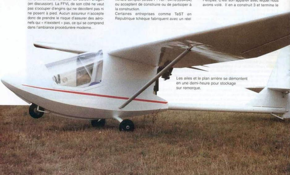
Les ailes et le plan arrière se démontent en une demi-heure pour stockage sur remorque.
