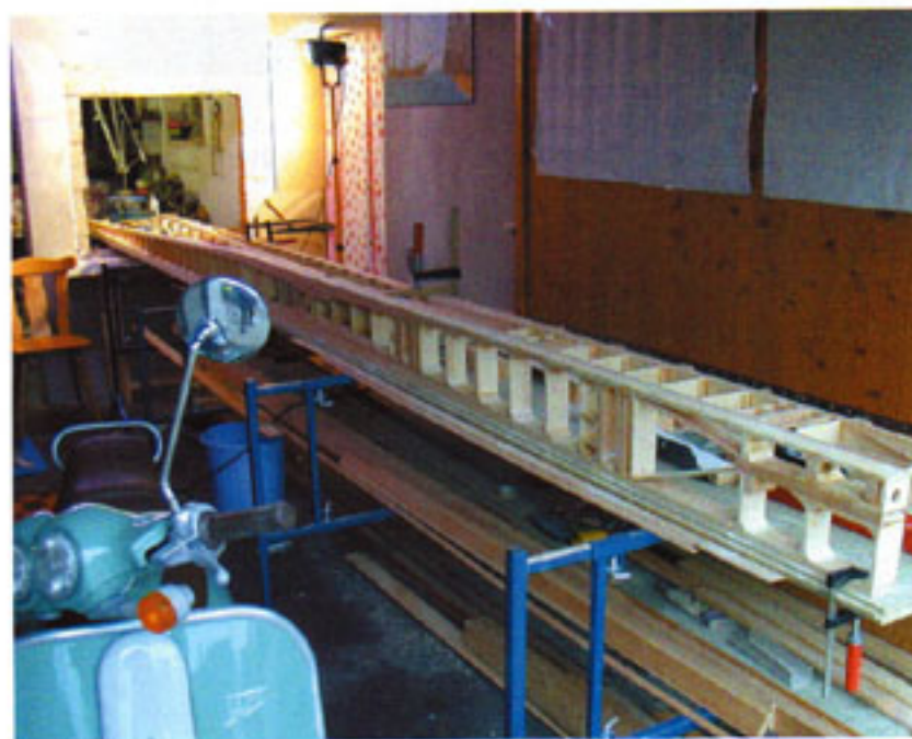
Bau der Holme.
